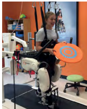
On essaie le Lokomat, un robot d'assistance à la rééducation à la marche.
